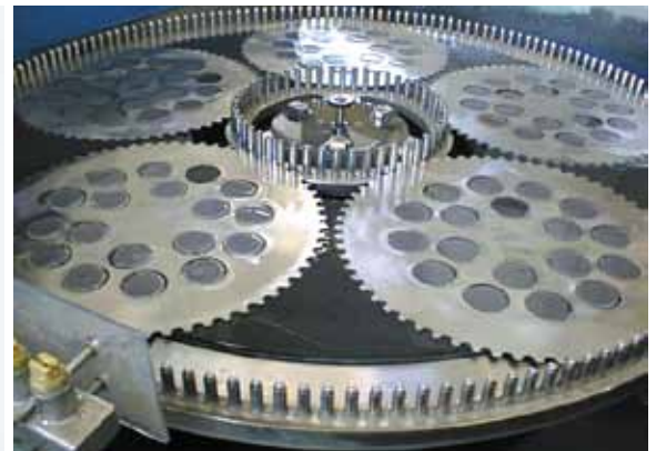
Untere Feinschleifscheibe mit Läuferscheiben Bottom precision grinding wheel with carriers
